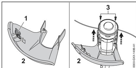
Le couteau rogneur (1) est déjà monté dans le capot protecteur (2) et il ne doit pas être démonté.
